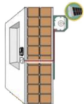
Der Motor wird mit einer zweipoligen 12-Volt-Leitung mit der Wandhalterung im Rauminneren verbunden. E-Port versorgt die Anlage mit Strom
